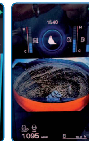
La retrocamera è di serie e si visualizza l'immagine nel monitor principale.
