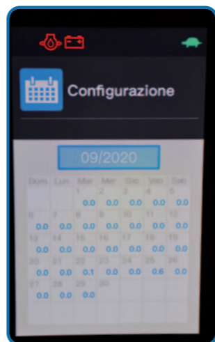
In una sola schermata si visualizzano le ore di lavoro per ogni giorno del mese.
