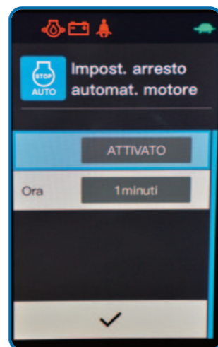
Lo spegnimento automatico del motore è impostabile da 1 a 30 minuti. Disattivabile.
