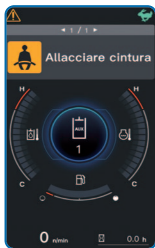
All'accensione il sistema rileva se la cintura è allacciata e lo segnala all'operatore.
