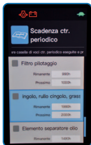
...ma anche di filtri secondari come quello dei pilotaggi o del condensatore olio.
