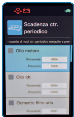
Il sistema permette il monitoraggio di olio motore e relativo filtro, olio idraulico...
