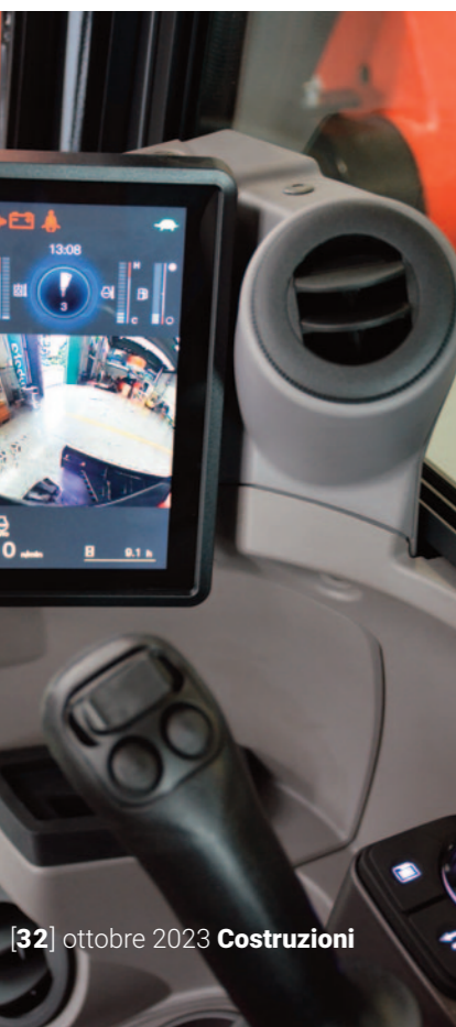
Il sistema permette il monitoraggio di olio motore e relativo filtro, olio idraulico...
